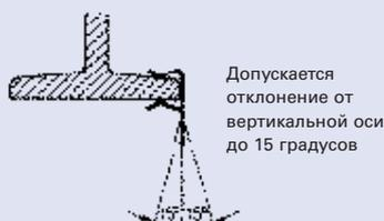
Допускается отклонение от вертикальной оси до 15 градусов
